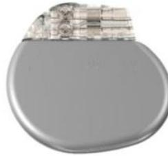
心臓の鼓動が途切れたことを検知すると、電気的刺激を心臓に送り、正常なリズムで鼓動させる
