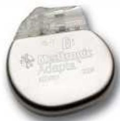
心臓の鼓動が途切れたことを検知すると、電気的刺激を心臓に送り、正常なリズムで鼓動させる
