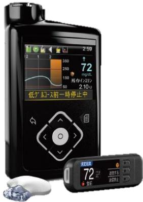
血糖値変動の測定データをインスリンポンプにプログラミングし、インスリンを持続的に体内に注入し、血糖値をコントロール
